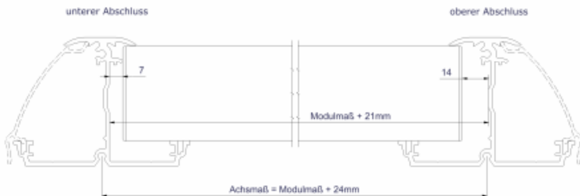
Bild 6 - Abstand Horizontalprofile
